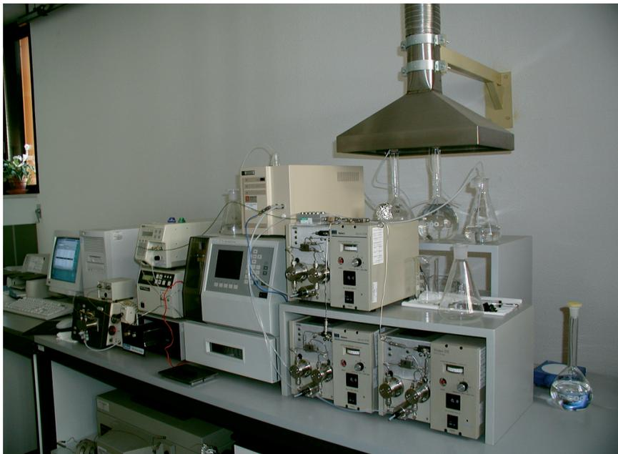
Cromatografo liquido ad alta pressione (HPLC)
