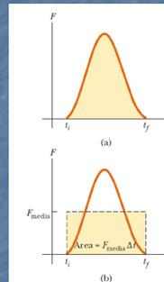
**FIGURA 8.4** (a) La forza risultante agente su una particella può variare col tempo. L'impulso è dato dalla area sotto la curva forza-tempo. (b) La forza media (linea tratteggiata orizzontale) imprime alla particella lo stesso impulso nel tempo  $\Delta t$  della forza variabile nel tempo descritta in (a). L'area del rettangolo è uguale all'area definita dalla curva.
