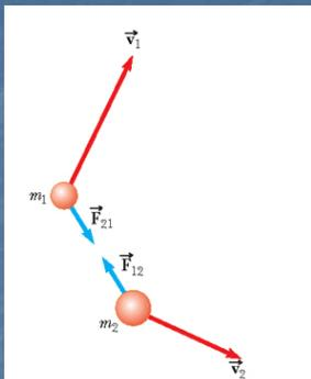
**FIGURA 8.1** Due particelle interagiscono l'una con l'altra. Secondo la terza legge di Newton, dobbiamo avere  $\vec{F}_{12} = -\vec{F}_{21}$ .
