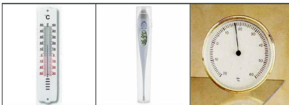
Termometro a liquido, digitale, a lamina bimetallica.
